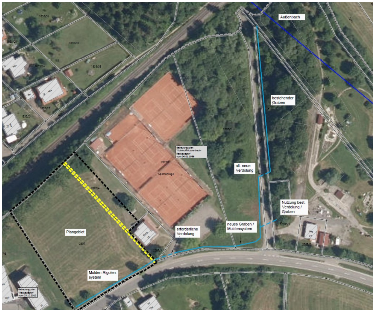
Abb. 6-1: Ableitungssystematik Niederschlagswasser skizziert
