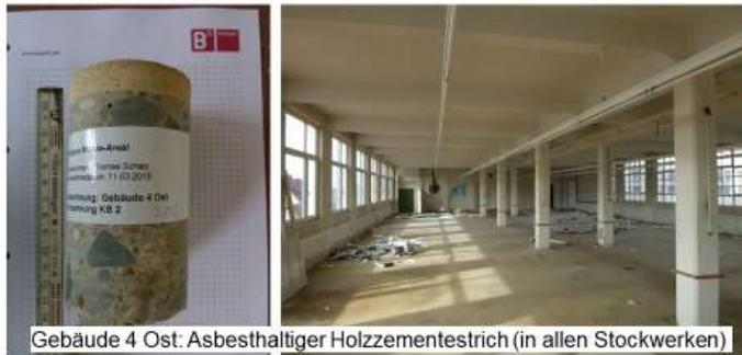
Gebäude 4 Ost: Asbesthaltiger Holzzementestrich (in allen Stockwerken)
