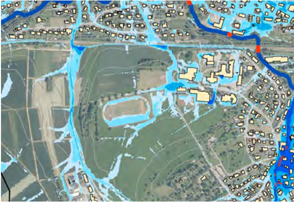
Abb. 8-1: Überflutungsausdehnung extremes Abflussereignis, verschlämmt
